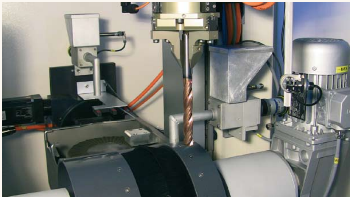
Bild 4: Bohrer in Position vor dem Polieren seiner beschichteten Spannuten
