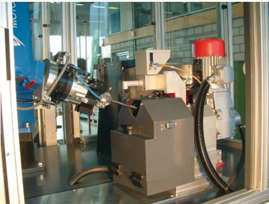
Bild 6: Bearbeitung der Hauptschneide eines Bohrers in der MF 72 (Werkbilder: Magnetfinish GmbH, CH-Oberdorf)
