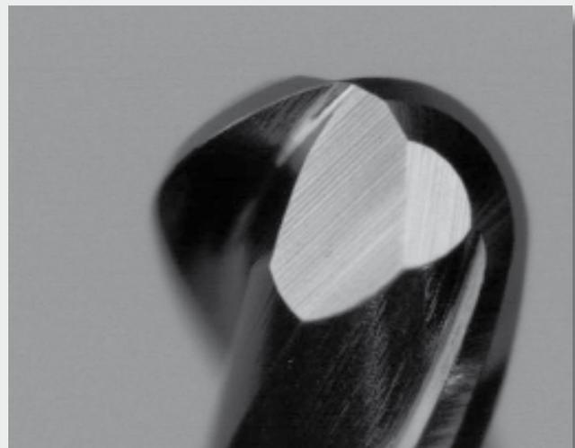
Nach MF-Bearbeitung: gleichmäßige Kantenverrundung, R=5 µm, 20s, grobes Pulver
